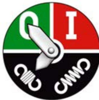
Fig.10 Interruptor abierto. Resorte de apertura destensado / Open circuit breaker. Open spring relaxed / Interrupteur ouvert. Ressort de coupure détendu
