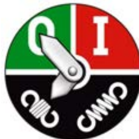
Fig.14 Interruptor abierto. Resorte de apertura destensado / Open circuit breaker. Spring relaxed / Interrupteur ouvert. Ressort de coupure détendu
